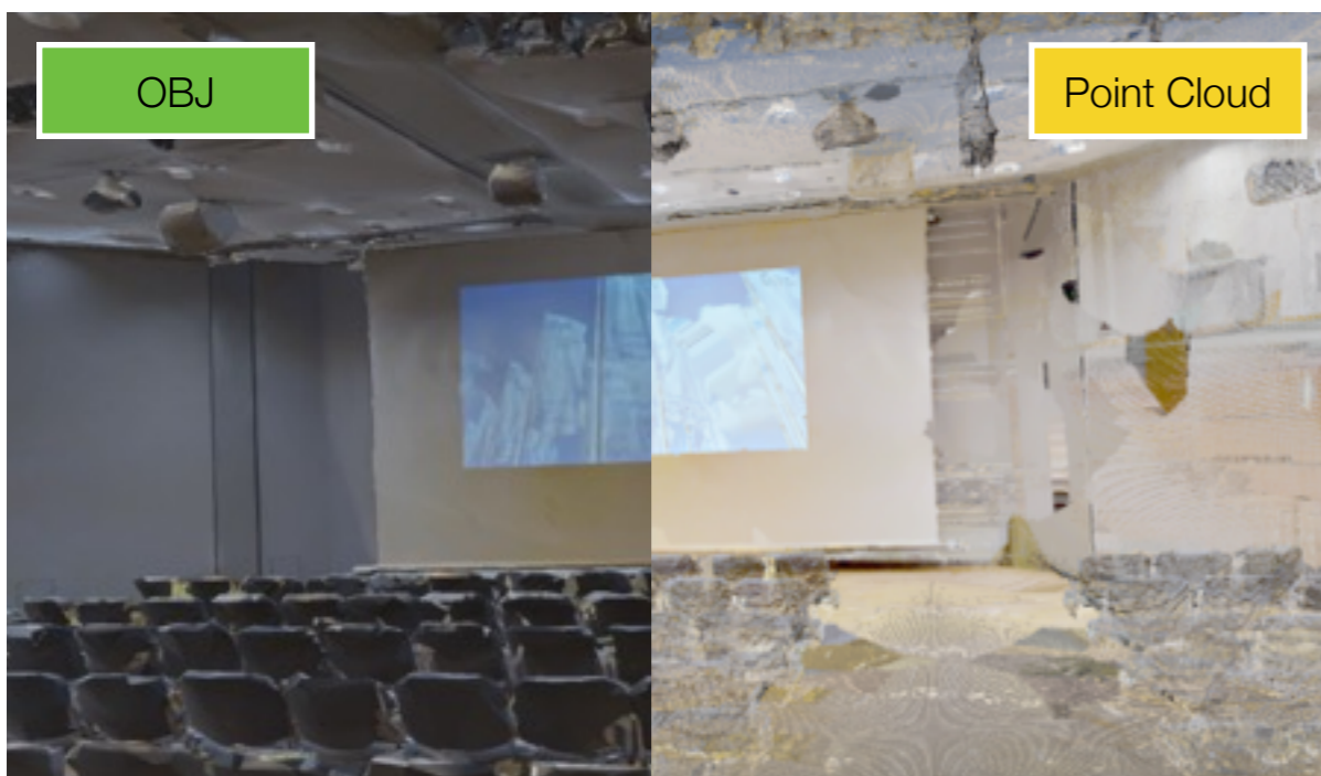
点群データ（右）、ポリゴンデータ（左）を切り替えて表示できる
